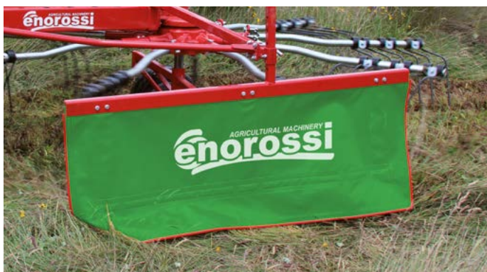
Bandella laterale per la formazione dell'andana. Lona lateral para la formación de la hilera.
