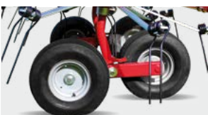
Ruote tandem sul modello trainato (G6V 740 PTH). Ruedas tándem en el modelo arrastrado (G6V 740 PTH).
