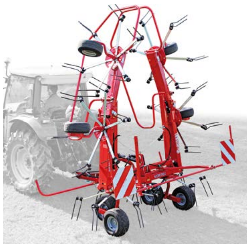
Versione trainata (modello G6V 740 PTH) in posizione di trasporto Versión arrastrada (modelo G6V 740 PTH) en posición de transporte.
